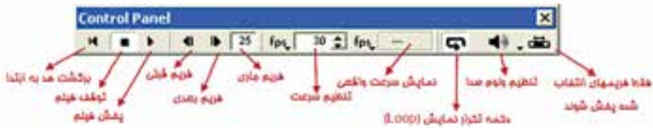
شکل ۲-۲۱: تابلوی کنترل (Control Panel)
